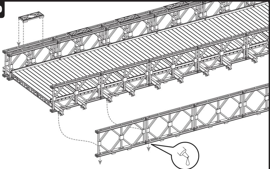
**NL** Klik de zijframes op de nokken van de dwarsbalken. Let op dat de frames met de juiste kant naar boven worden geplaatst en dat ze in de lengterichting met elkaar overeenkomen. Lijm de afstandhouders op de aangegeven plaatsen.
